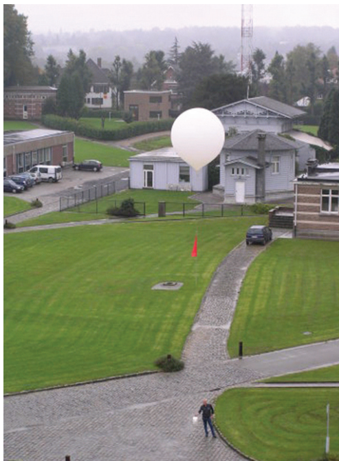
Figuur 13. Lancering van een ballon met sonde te Ukkel.
